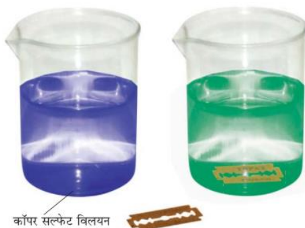
चित्र 6.4 लोहे के साथ अभिक्रिया के कारण कॉपर सल्फेट विलयन के रंग में परिवर्तन
